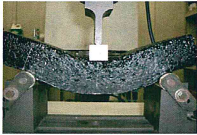
物性試験（繰り返し曲げ試験）
